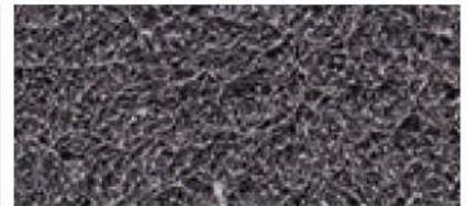
La tramatura ampia permette la fuga del materiale asportato evitando così il fenomeno dell'intasamento garantendoci un lavoro di qualità ed efficiente.
