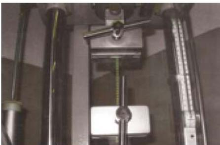
Test di resistenza del filato delle reti di rinforzo.
