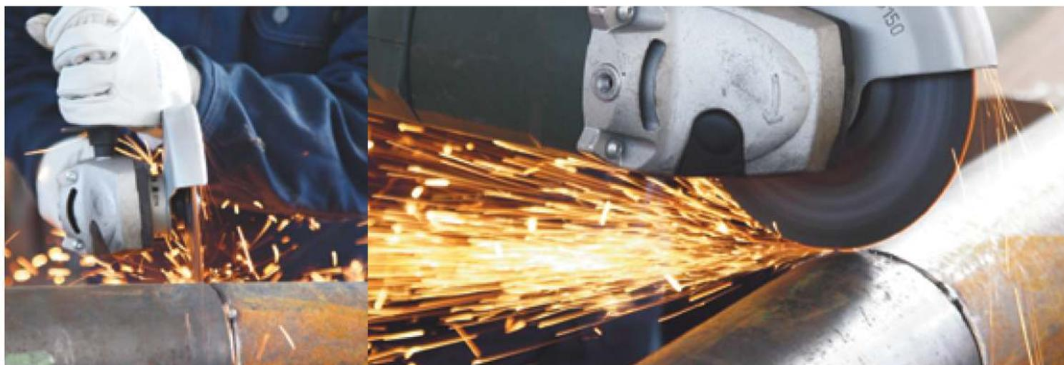
**PIPELINER** è la linea per il taglio, lo sbavo e la cianfrinatura sviluppata per la preparazione, l'incisione e la saldatura dei tubi. Questi dischi sono appositamente formulati e rinforzati per la rettifica di saldature ad arco tra passaggi nella costruzione di pipeline. Non contengono ferro, zolfo o cloro (Fe, S, Cl) per non contaminare l'acciaio inossidabile.
