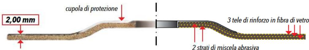
La struttura interna di **Combi Speed**.
