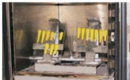
Prova di scorrimento delle resine fenoliche in polvere.
