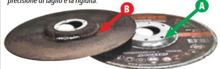
Grazie all'utilizzo dello speciale "SPACER" e alla forma a centro depresso, l'albero della macchina e la ghiera di serraggio non sporgono dalla cavità della cupola del disco, consentendo all'operatore di effettuare tagli a raso in posizione ergonomica e confortevole. La forma a centro depresso conferisce inoltre una maggior rigidità rispetto ad un disco piano limitandone la flessione e consentendo d'effettuare tagli perfettamente diritti.
