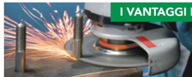
Taglio a raso possibile grazie alla conformazione a centro depresso unitamente all'uso dello "SPACER".
